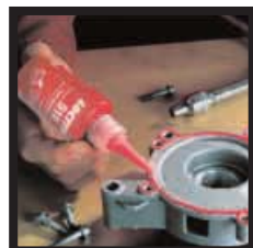
Loctite® 510 Zum Dichten steifer Flansche. Empfohlen zum Dichten stei- fer Flansche in Pumpen, Kupplungen, Getrieben und Motorblöcken. Loctite® 510 ist thixotrop und kann auf vertikale Flächen aufge- tragen werden, ohne zu tropfen oder zu verlaufen. P1 NSF Reg. No.: 123007
